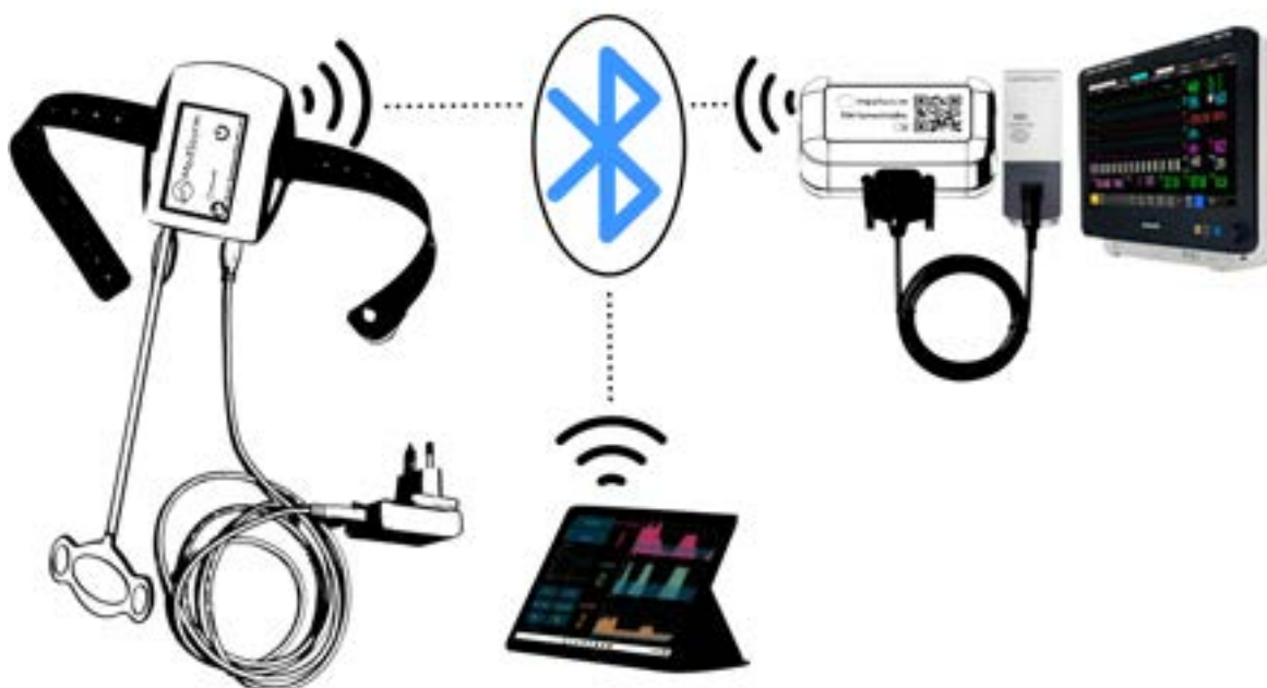
Figur3-1 Systemöversikt. PainSensor med armband, laddare och elektroder visas på vänster sida av bluetooth-symbolen. Anslutningsalternativen visas under bluetooth-symbolen (surfplatta med PSS-programvara) och på höger sida av bluetooth-symbolen (anslutningsbox till patientmonitorer).
