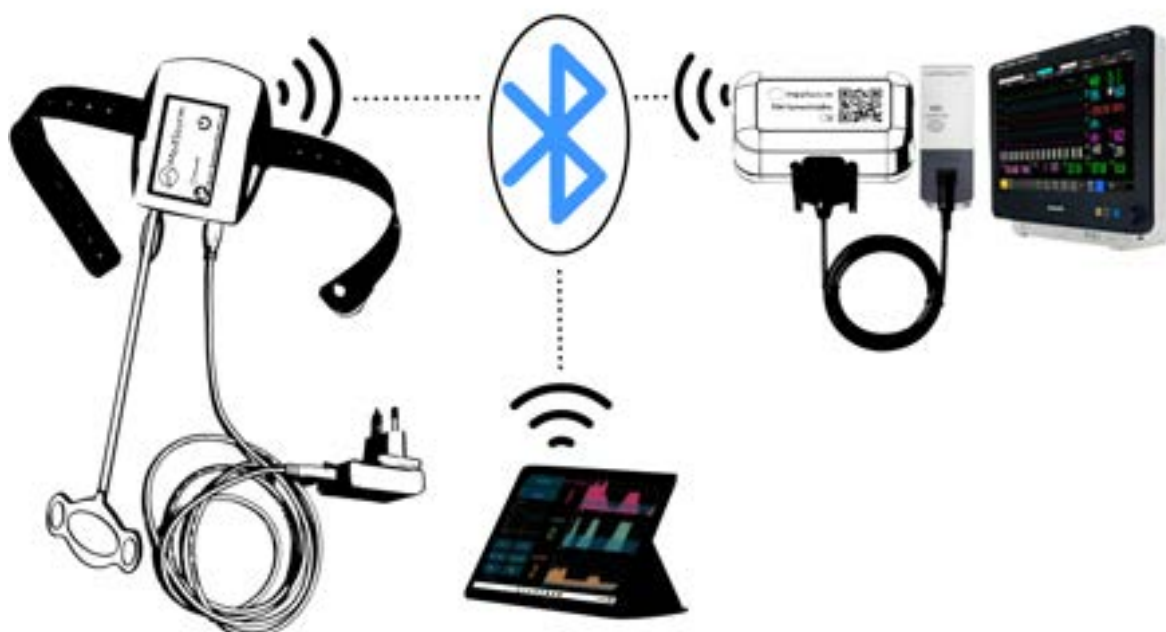
Figur3-1 Systemoversikt. Smertesensoren med armbånd, lader og elektroder vises på venstre side av bluetooth-symbolet. Tilkoblingsalternativene vises under bluetooth-symbolet (nettbrett med PSS-programvare) og på høyre side av bluetooth-symbolet (tilkoblingsboks til pasientmonitorer).
