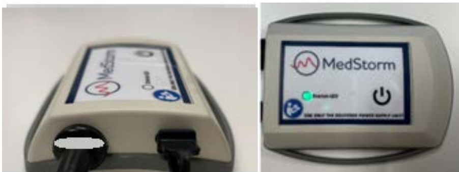
Afbeelding 3-3: De stekker die de USB-oplaadpoort afdekt wanneer de oplaadkabel niet is aangesloten. De afbeeldingen tonen de stekker die in de USB-oplaadpoort is gestoken.
