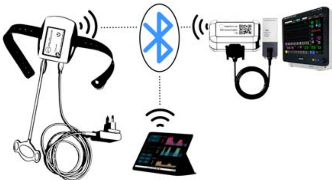
Figura 3-1 Visão geral do sistema. O PainSensor com pulseira, carregador e eletrodos são mostrados no lado esquerdo do símbolo do Bluetooth. As opções de conectividade são mostradas abaixo do símbolo do Bluetooth (tablet com software PSS) e no lado direito do símbolo do Bluetooth (caixa de conectividade para monitores de pacientes).
