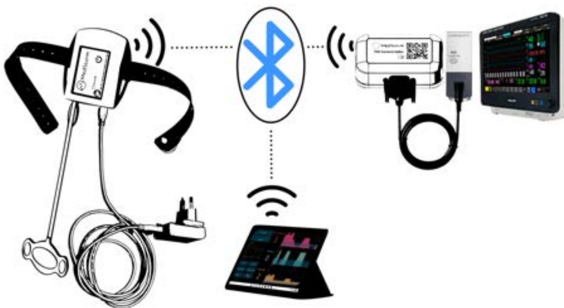
Figura 31 Panoramica del sistema. Il PainSensor con cinturino, caricabatterie ed elettrodi sono mostrati sul lato sinistro del simbolo Bluetooth. Le opzioni di connettività sono mostrate sotto il simbolo Bluetooth (tablet con software PSS) e sul lato destro del simbolo Bluetooth (casella di connettività ai monitor dei pazienti).
