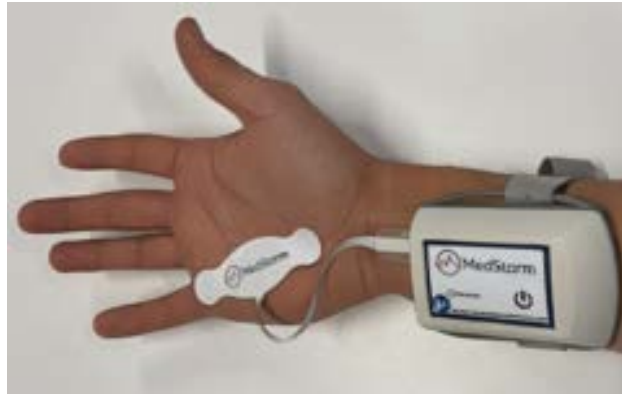
Afbeelding 4-1: Voorbeeld van plaatsing van de behuizing van de pijnsensor aan de onderkant van de arm, indien dit handiger wordt geacht in de operatiekamer
