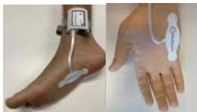
Figura41: posizionamento degli elettrodi sotto il piede o nel palmo della mano
