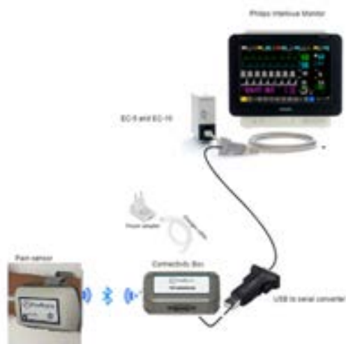
Figura 6-1: Configuração para conexão com monitores Philips com a caixa de conectividade PSM
