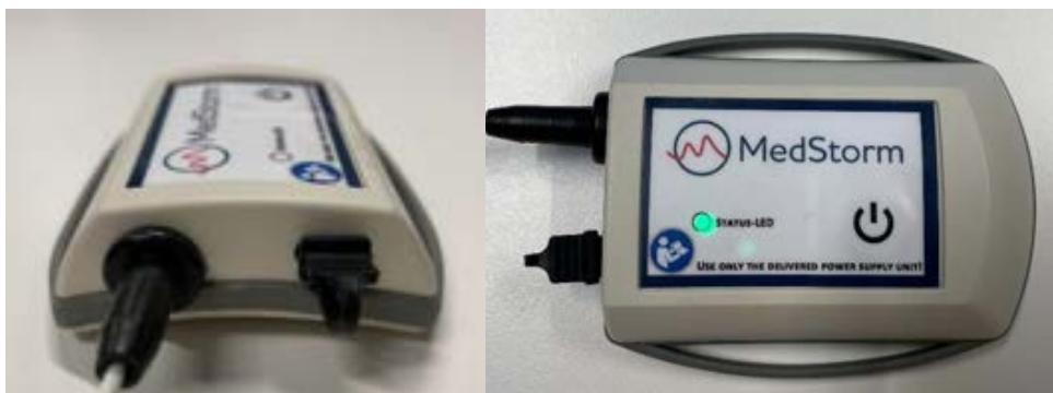
Schéma 3-3 : Le cache qui recouvre le port USB de charge lorsque le câble de charge n'est pas fixé. L'image de gauche montre le cache, et l'image de droite montre le cache insérée dans le port USB de charge.
