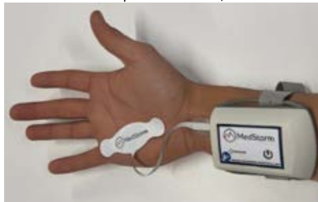
Abbildung 4-1: Beispiel für die Platzierung des PainSensor-Gehäuses an der Unterseite des Arms, wenn dies zum Beispiel im Operationssaal zur besseren Positionierung dienlich ist.
