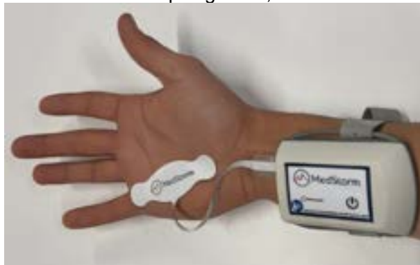
Figur 4-1: Eksempel på, hvordan man placerer smertesensoren på undersiden af arm, når det anses for at være det mest bekvemme/tilgængelige sted på operationsstuen.
