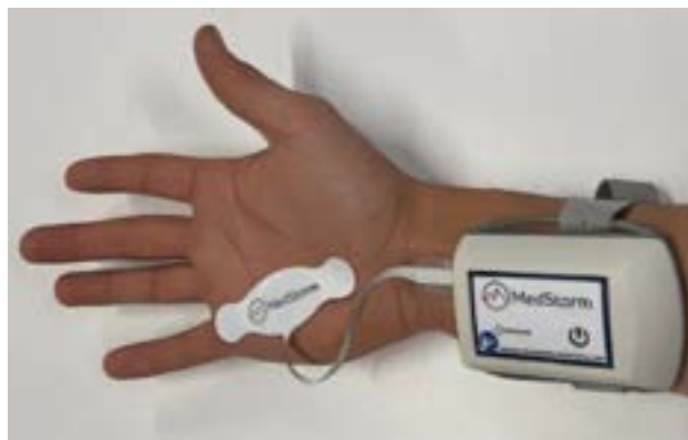
Figura 4-1: Ejemplo de colocación de la carcasa del PainSensor en la parte inferior del brazo si se considera más conveniente en el quirófano
