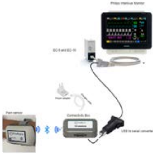
Figür6-1: PSM bağlantı kutusu ile Philips monitörlere bağlanma kurulumu
